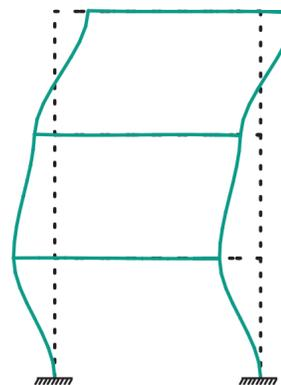
Zur Berechnung der Eigenkreisfrequenzen des oben abgebildeten Stockwerkrahmens aus Stahlbeton C20/25 wurden die Massen  $m_1$  bis  $m_3$  der Decken samt Unterzug und den darüber liegenden Stützen erfasst und als Punktmassen auf die Rahmenecken aufgeteilt. Der E-Modul wurde zur Berücksichtigung der Rissbildung auf 90% reduziert. Die Decken und Unterzüge lassen sich zu Riegeln mit einem Flächenträgheitsmoment von  $I = 3,76 \cdot 10^{-3} \text{m}^4$  zusammenfassen.
